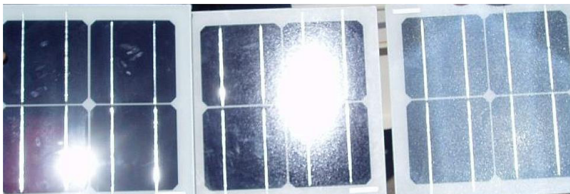
Bild 3.2.3: Diffuse Reflexion von unterschiedlichen Moduloberflächen (Quelle: Sandia National Laboratories)
